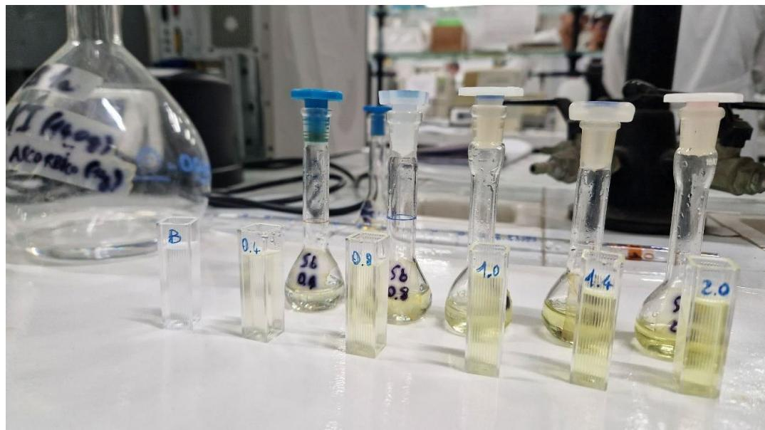
Seguendo la procedura precedentemente descritta, acquisire per ciascuna soluzione, compresa quella più concentrata, **un totale di due letture di assorbanza a 435 nm e due a 450 nm.**
