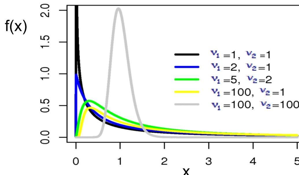
Date le variabili random  $A$  e  $B$ , distribuite rispettivamente secondo  $\chi^2_{v_1}$  e  $\chi^2_{v_2}$ , la variabile  $(A/v_1)/(B/v_2)$  è distribuita secondo una distribuzione  $F_{v_1, v_2}$ .
