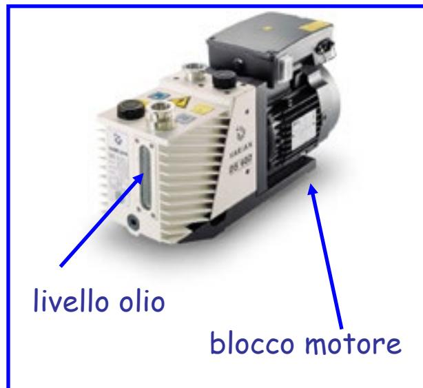
Il limite di pressione raggiungibile è di  $10^{-3}$  torr, con una velocità di pompaggio dell'ordine di 60  $m^3/h$ .
