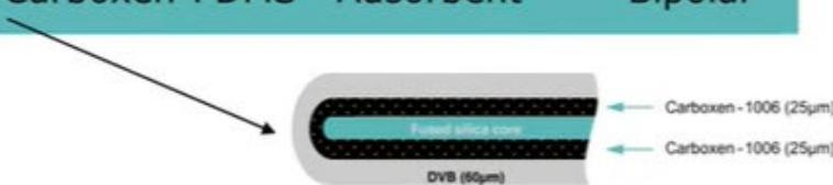
Il Carboxen è un materiale brevettato, a base di carbonio poroso, utilizzato per l'estrazione di composti relativamente poco polari mediante adsorbimento.
