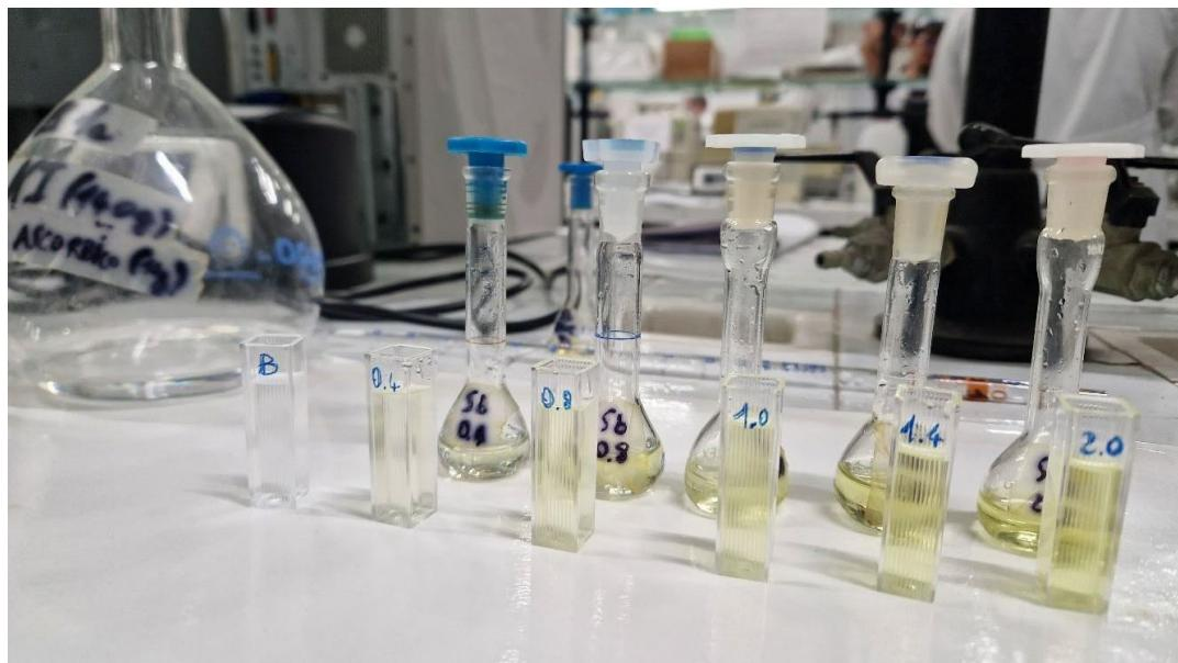
Seguendo la procedura precedentemente descritta, acquisire per ciascuna soluzione, compresa quella più concentrata, **un totale di due letture di assorbanza a 435 nm e due a 450 nm.**
